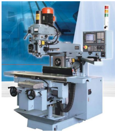
Şekil 1.4. Deneyde kullanılan NC kontrollü Freze tezgahı [15]
