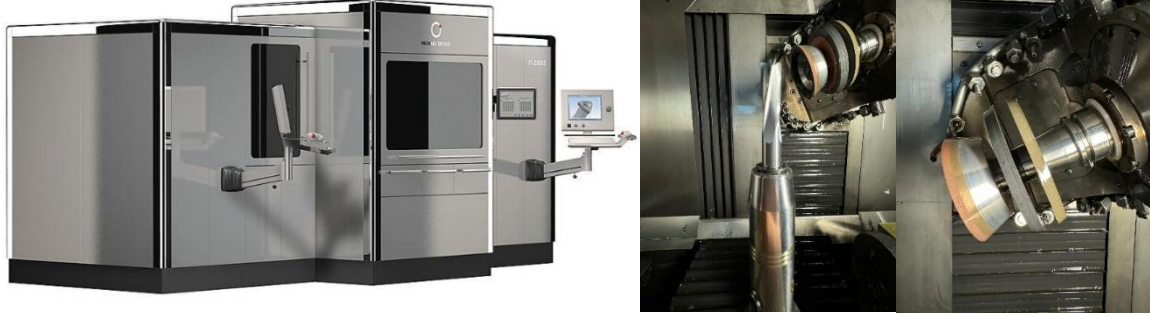
Şekil 1.1. Flexus S22 5 eksen CNC taşlama tezgahı ve diamond taşlar [14]
