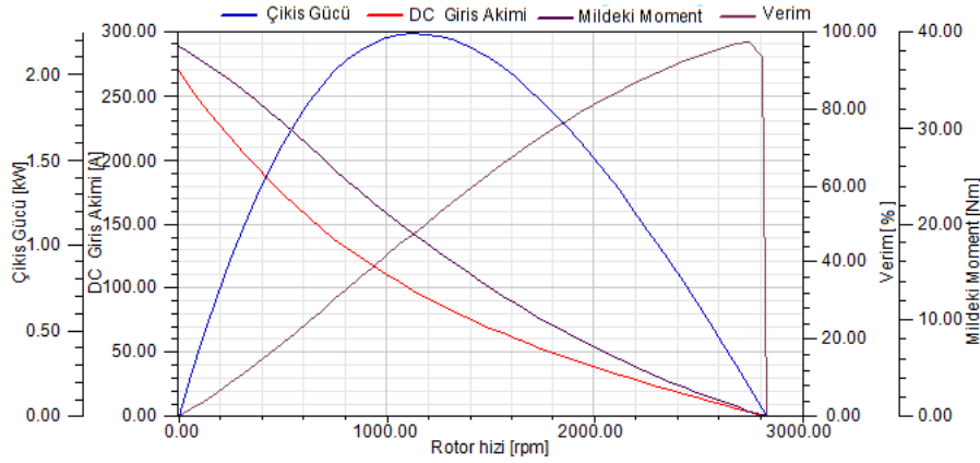
Görsel 5. Rotor hızına bağlı motorun çıkış gücü, akımı, verimi ve mildeki moment değişimi
