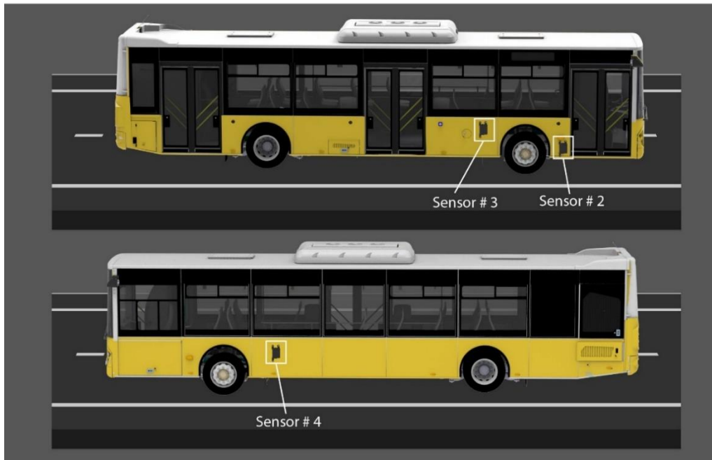
Görsel 3. BSIS Sensörlerinin Araç Üzerindeki Konumları
